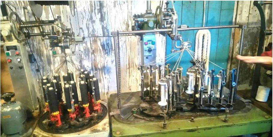
Détail d'une machine à corder
